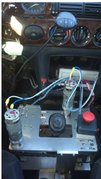
Figura 3.15: Comutador de velocidades, montagem final
