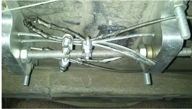
Figura 2.11: Sistema de ajuste dos pedais colocado sob o veículo
