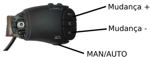
Figura 2.5: Comando de áudio adaptado para seleção de modo (manual ou automático) e de velocidade [15]
